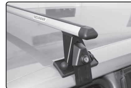
Na boční úchyty nasadte uzamykatelný kryt a pomocí klíče uzamkněte.
